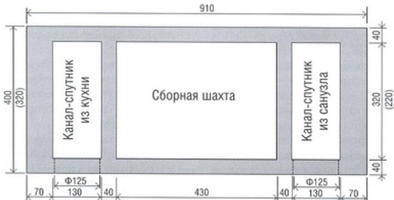
Поперечное сечение вентиляционного блока с двумя каналами-спутниками
