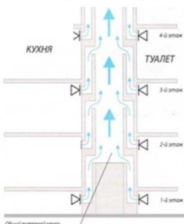
**Вентиляция естественная** (аэрация) - воздухообмен, осуществляемый либо под действием разности удельных весов (температур) наружного и внутреннего воздуха, либо под влиянием ветра, либо совместным их действием, а также комплекс технических средств для реализации такого воздухообмена.
