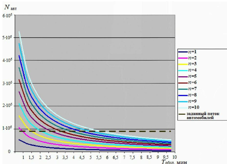
Рисунок Б.1 - Пропускная способность как функция времени обслуживания для различного числа полос пропускания
