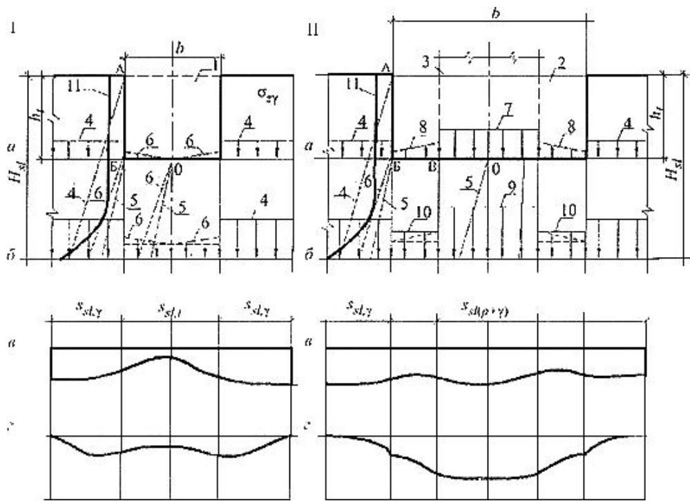
*a* - эпюры вертикальных напряжений на глубине  $h_1$  - уровень дна выемки или котлована; *б* - то же, на глубине  $H_{sl}$ ; *в* - кривая просадки грунта и фундамента при подъеме уровня подземных вод; *г* - то же, при замачивании через дно выемки или днища подземной части здания.
