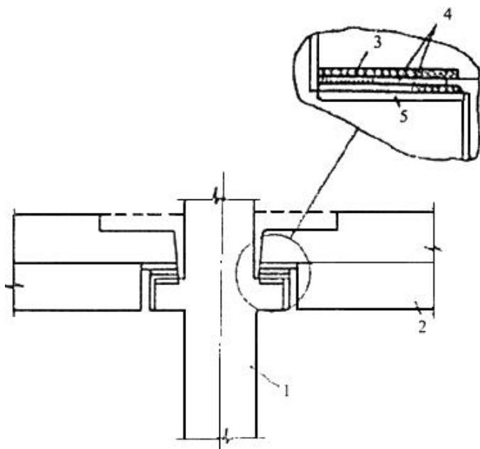
1 - колонна; 2 - шарнирно-опертыи ригель; 3 - закладная деталь ригеля; 4 - нижняя и верхняя связевые пластины; 5 - закладная деталь колонны
