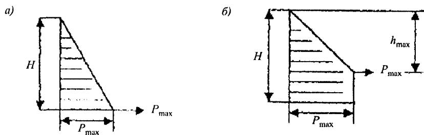
а - гидростатическое давление; б - расчетное давление
