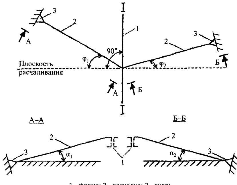
Рисунок К.2. Схема раскрепления ферм расчалками
