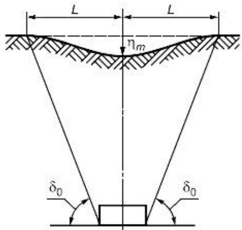
б) Разрез вдоль объекта (полная подработка)
