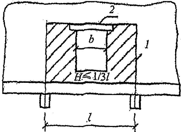
*I* – нагрузка на рандбалку; *2* – железобетонная перемычка
