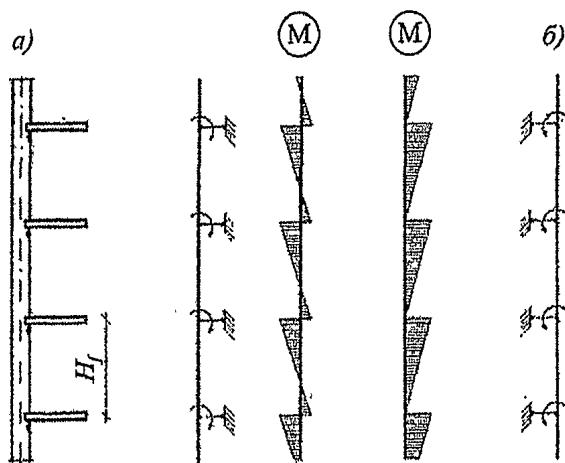
*a – стена рассчитывается как неразрезная балка; б – стена рассчитывается в пределах каждого этажа как однопролетная балка*
