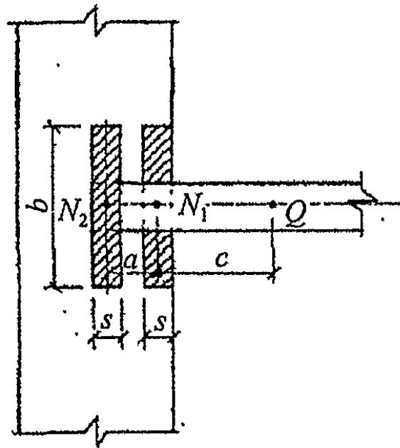
**Рисунок 14 – Расчетные схемы заделки консольных балок**
