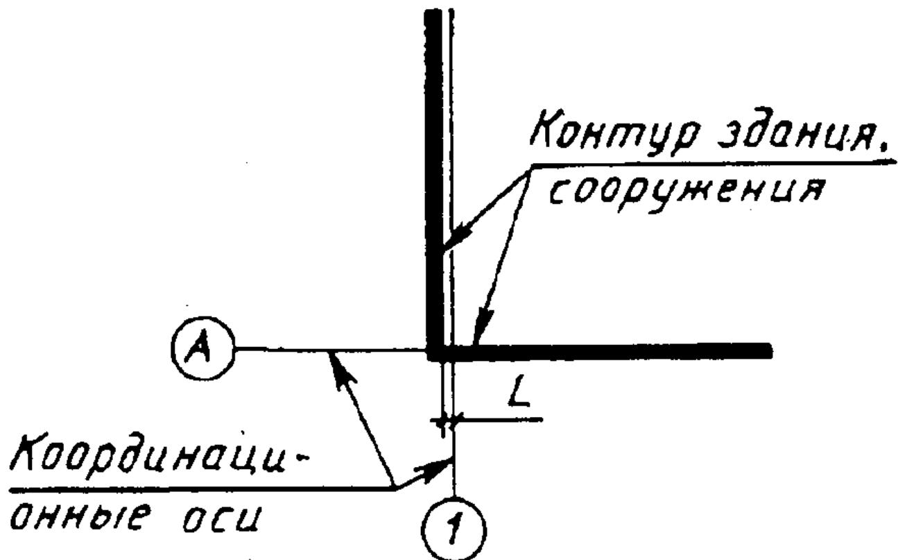
Примечание - L - расстояние от внутренней грани контура здания, сооружения до координационной оси.
