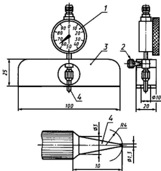
1 - шкала индикатора; 2 - стопорный винт; 3 - колодка;
