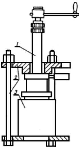
1 - фильтратометр; 2 - крепежное устройство; 3 - бетонный образец
