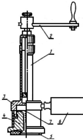
1 - гидравлический насос; 2 - ручка насоса; 3 - рабочий цилиндр;
