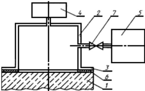
1 - бетонный образец; 2 - камера устройства; 3 - фланец камеры; 4 - вакуумметрический датчик;
