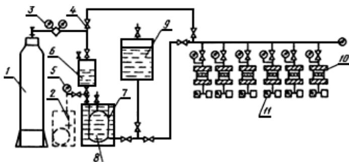
1 - баллон с газом; 2 - насос; 3 - редуктор; 4 - вентиль; 5 - манометр; 6 - передатчик давления;
