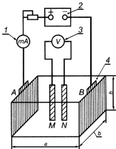
1 - миллиамперметр; 2 - источник тока; 3 - вольтметр; 4 - измерительная ячейка размерами  $a$ ,  $b$ ;  $h$  (см. А.2.2);
