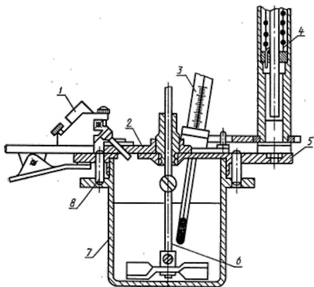
1 - зажигающая горелка; 2 - заслонка; 3 - термометр; 4 - пружинный механизм;
