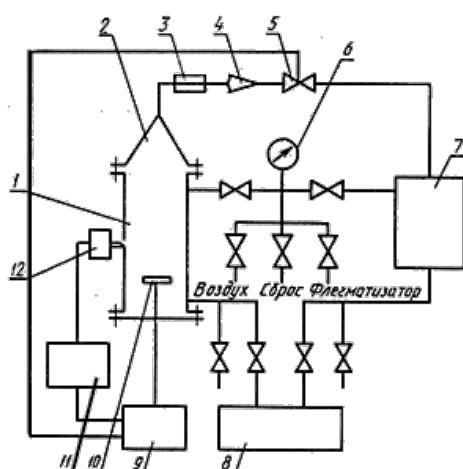
1 - реакционный сосуд; 2 - конус распылителя; 3 - форкамера; 4 - обратный клапан;
