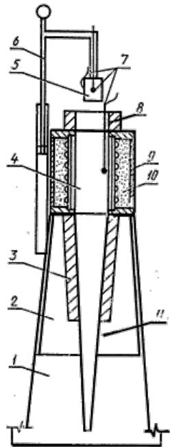
1 - подставка; 2 - вытяжка; 3 - теплоизоляционный слой защитного экрана и стабилизатора;
