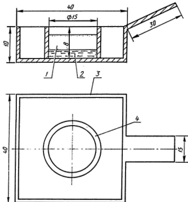
1 - песок; 2 - жидкость; 3 - лодочка; 4 - цилиндрическая емкость
