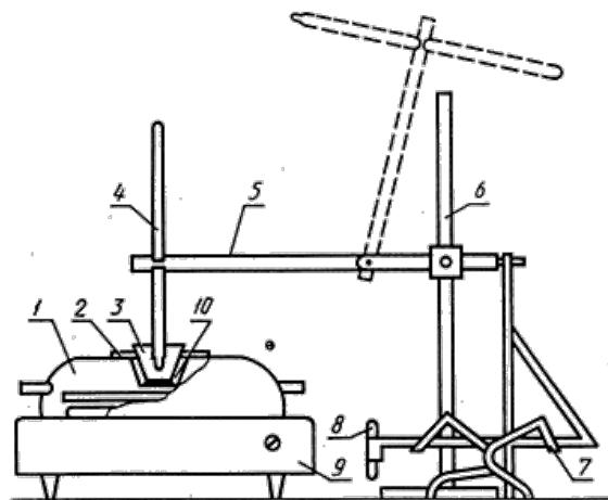
1 - нагревательная ванна; 2 - кольцо из паронита; 3 - фарфоровый тигель; 4 - термометр;
