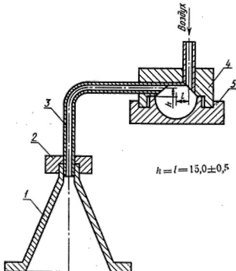
1 - конус; 2 - гайка накидная; 3 - патрубок; 4 - корпус форкамеры; 5 - донышко
