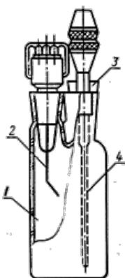
1 - реакционный сосуд; 2 - зажигающее устройство; 3 - сбросной клапан;
