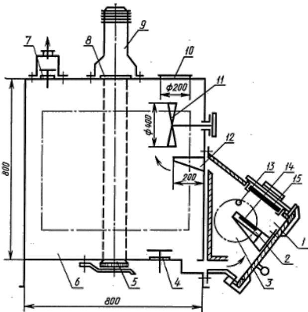
1 - камера сгорания; 2 - держатель образца; 3 - окно из кварцевого стекла; 4, 7 - клапаны продувки; 5 - приемник света; 6 - камера измерений; 8 - кварцевое стекло; 9 - источник света;
