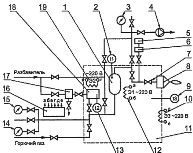
1 - ресивер; 2 - первичный термопреобразователь  $t^1$ ; 3 - вакуумметр; 4 - вакуумный насос;
