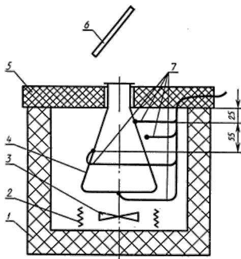
1 - корпус термостата; 2 - электрическая спираль нагревателя; 3 - крыльчатка вентилятора;
