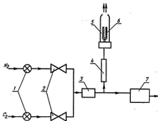
1 - вентиль предварительной регулировки; 2 - вентиль точной регулировки; 3 - смеситель; 4 - расходомер;
