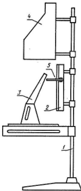
1 - стойка; 2 - электрическая радиационная панель; 3 - рамка держателя образца;
