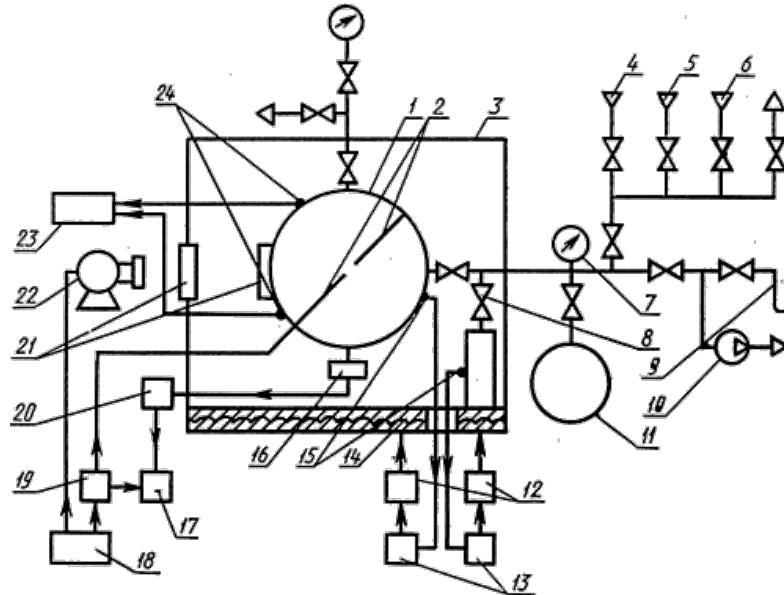
1 - реакционный сосуд; 2 - электроды зажигания; 3 - термостат; 4 - линия подачи горючего;
