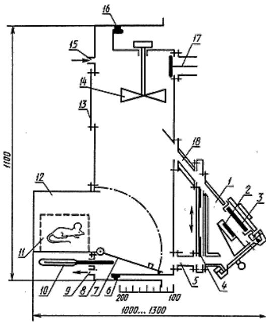
1 - камера сгорания; 2 - держатель образца; 3 - электронагревательный излучатель; 4 - заслонки;
