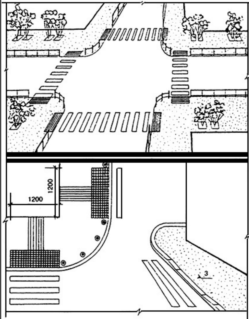
[Hatched area] - участок тротуара с рельефным покрытием
