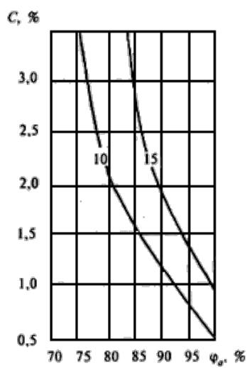
Рисунок Щ.5 - Изолинии сорбционного влагосодержания керамзитобетона  $P_0 = 1200 \text{ кг}/\text{м}^3$ , содержащего NaCl - 50%, KCl - 30%, MgCl<sup>2</sup> - 10%, при изменении относительной влажности воздуха  $\varphi_a$ , %, и массового солесодержания  $C$ , %, в стенах цехов дробления руды
