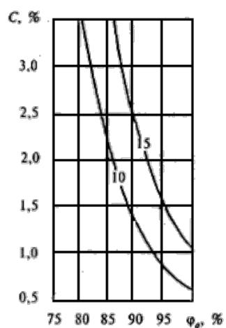
Рисунок Щ.2 - Изолинии сорбционного влагосодержания керамзитобетона  $P_0 = 1200 \text{ кг}/\text{м}^3$ , содержащего хлорид калия, при изменении относительной влажности воздуха  $\varphi_a$ , %, и массового солесодержания  $C$ , %
