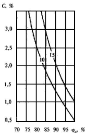
Рисунок Щ.6 - Изолинии сорбционного влагосодержания керамзитобетона  $\rho_0 = 1200 \text{ кг}/\text{м}^3$ , содержащего NaCl - 30%, KCl - 60%, MgCl<sub>2</sub> - 10%, при изменении относительной влажности воздуха  $\varphi_a$ , %, и массового солесодержания  $C$ , %, в стенах цехов сушки
