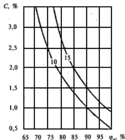
Рисунок Щ.1 - Изолинии сорбционного влагосодержания керамзитобетона  $P_0 = 1200 \text{ кг}/\text{м}^3$ , содержащего хлорид натрия, при изменении относительной влажности воздуха  $\varphi_a$ , %, и массового солесодержания  $C$ , %
