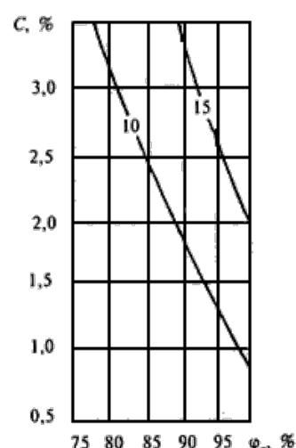
Рисунок Щ.3 - Изолинии сорбционного влагосодержания керамзитобетона  $P_0 = 1200 \text{ кг}/\text{м}^3$ , содержащего хлорид магния, при изменении относительной влажности воздуха  $\varphi_a$ , %, и массового солесодержания  $C$ , %
