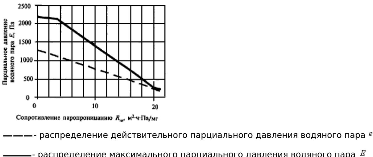
Рисунок Э.1 - Распределение парциального давления водяного пара в ограждающей конструкции (слева направо - от внутренней поверхности к наружной)
