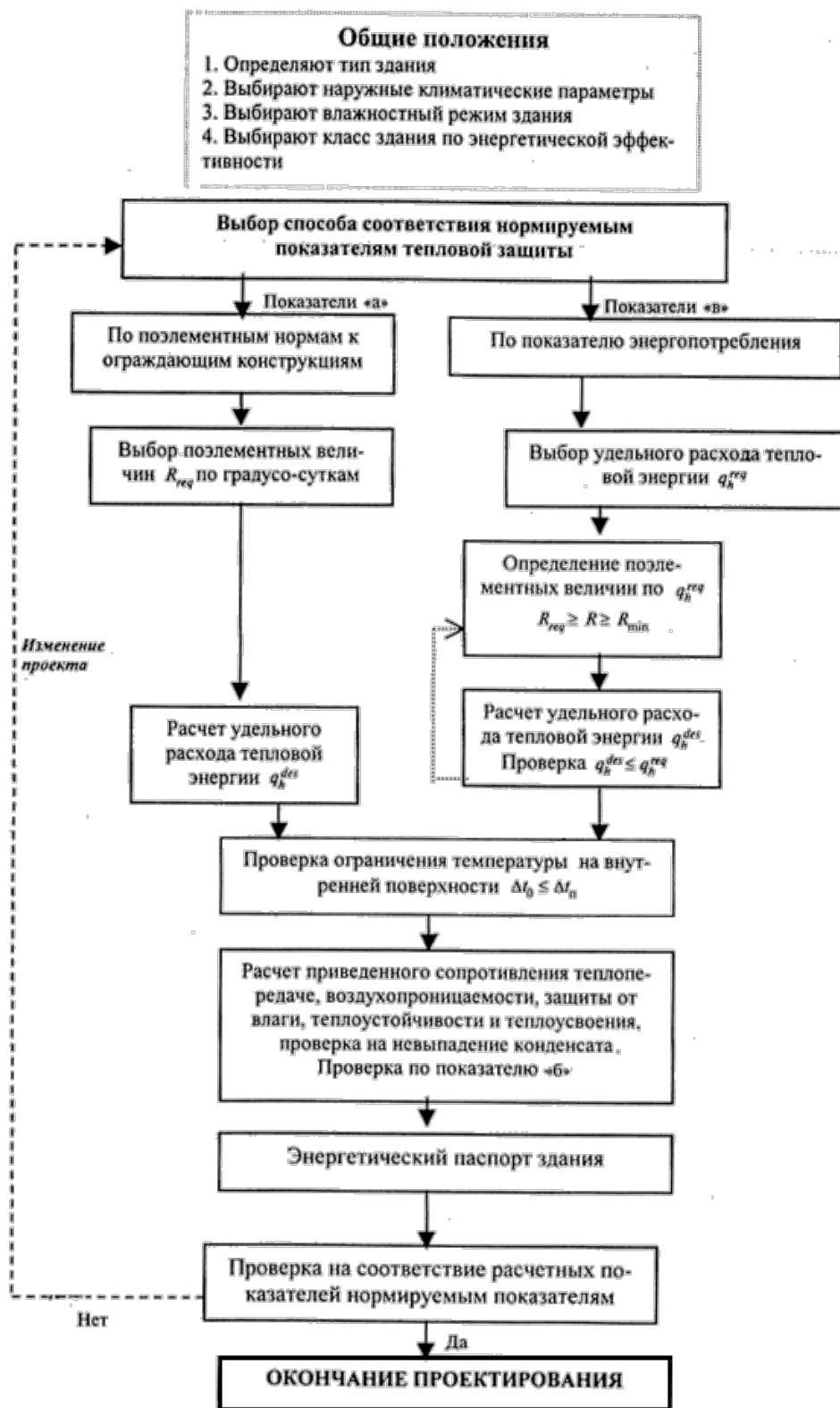
Рисунок 1 - Схема проектирования тепловой защиты зданий
