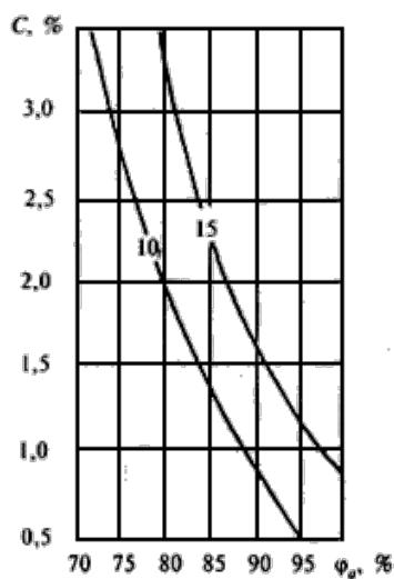
Рисунок Щ.4 - Изолинии сорбционного влагосодержания керамзитобетона  $P_0 = 1200 \text{ кг}/\text{м}^3$ , содержащего NaCl - 60%, KCl - 30%, MgCl<sup>2</sup> - 10%, при изменении относительной влажности воздуха  $\varphi_a$ , %, и массового солесодержания  $C$ , %, в стенах флото-фабрик
