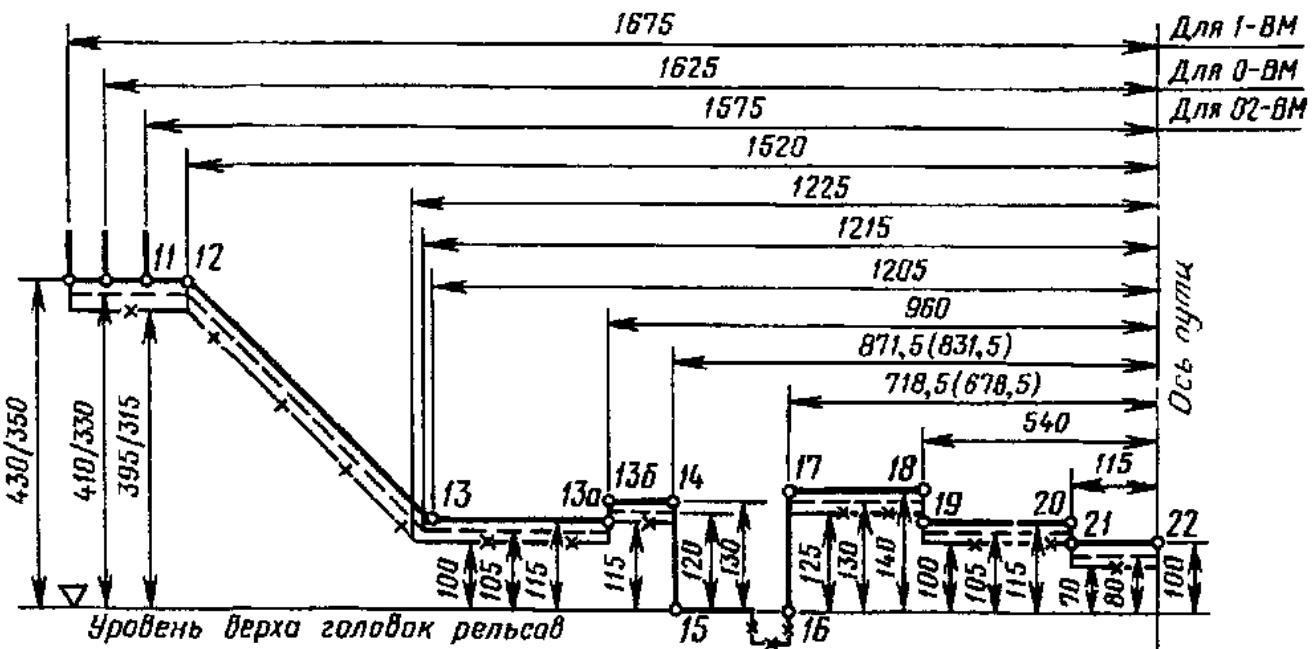
д) Для подвижного состава, проходящего по путям железных дорог Союза ССР колеи 1520 (1524) мм и путям железных дорог - членов ОСЖД колеи 1435 мм, включая пути сортировочных горок, оборудованные вагонными замедлителями, и пути, оборудованные устройством для надвига вагонов (см. черт. 6).
