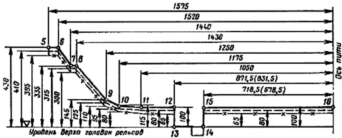
б) Для подвижного состава, проходящего по путям железных дорог Союза ССР колеи 1520 (1524) мм, а также европейских и азиатских железных дорог колеи 1435 мм, включая пути сортировочных горок, оборудованные вагонными
