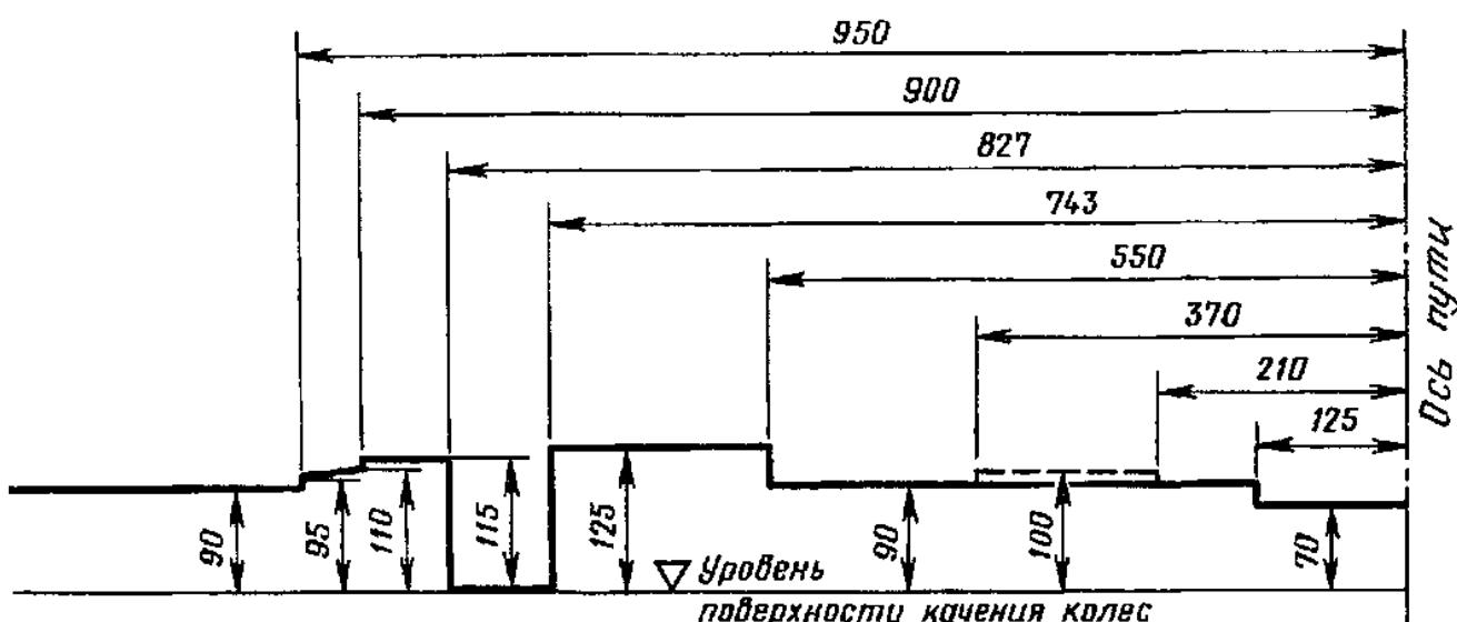
б) Очертание, за пределы которого не должна выступать ни одна из частей вагонного замедлителя при его нерабочем (отторможенном) положении.
