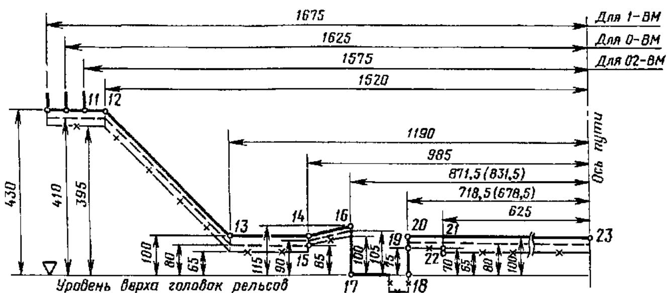
в) Для подвижного состава, проходящего по путям железных дорог Союза ССР колеи 1520 (1524) мм и путям железных дорог - членов ОСЖД колеи 1435 мм, включая пути сортировочных горок железных дорог Союза ССР, оборудованные вагонными замедлителями при любом их положении.
