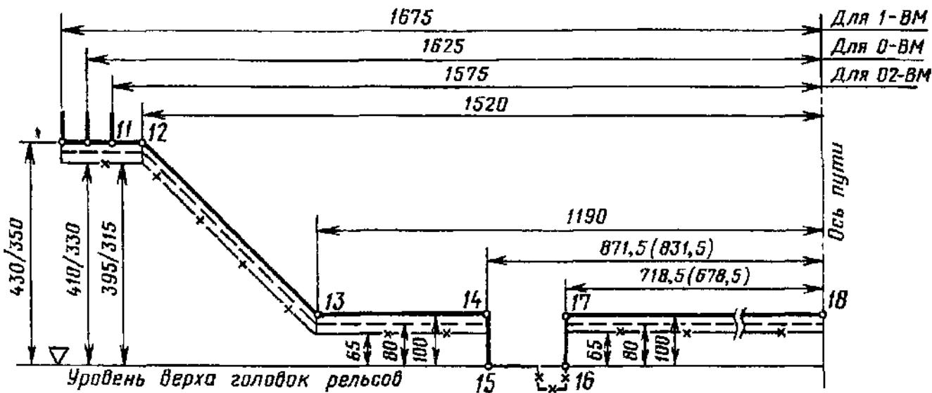
б) Для подвижного состава, проходящего по путям железных дорог Союза ССР колеи 1520 (1524) мм и путям железных дорог - членов ОСЖД колеи 1435 мм, включая пути сортировочных горок железных дорог Союза ССР, оборудованные вагонными замедлителями, при нерабочем (отторможенном) их положении.
