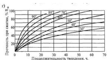
Рис. 5 графики набора прочности бетоном при различных температурах его выдерживания
