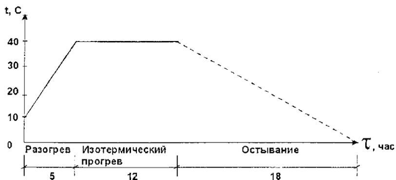
В период подъема температуры, на стадии изотермического прогрева, а также после каждого переключения напряжения необходимо следить за показаниями измерительных приборов, состоянием контактов и отпаек.
