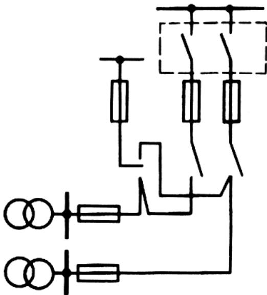
Рис.6. Схемы питания жилых 17-25-этажных домов и более
