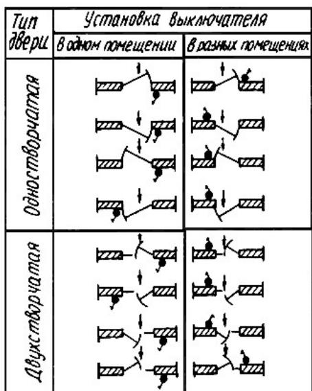
Рис.41. Места установки выключателей в помещениях
