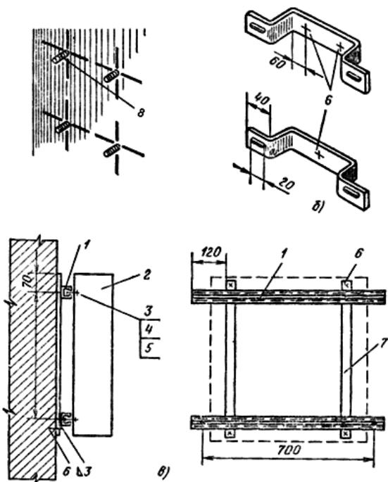
Рис.33. Крепление щитков открытой установки
