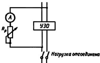
Рис.43. Схема проверки УЗО по методу 2.
