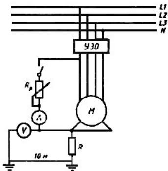
Рис.44. Схема проверки УЗО по методу 3.
