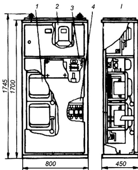
Рис. 11 Устройства, собираемые из панелей одностороннего обслуживания шкафного или открытого типа, могут быть однопанельными (I) и многопанельными (II)
