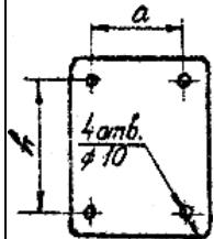
Рис.39. Размеры для открытого крепления щитков
