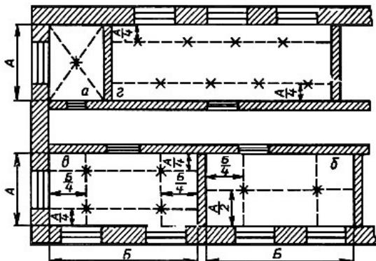
Рис.40. Разметка мест установки светильников в помещениях
