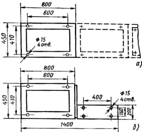
Рис.32.Установочные размеры вводных панелей
