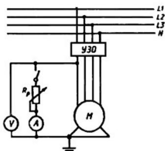
Рис.42. Схема проверки УЗО по методу 1.
