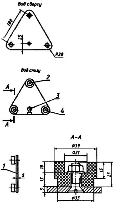
Рис.45. Испытательный электрод 2
