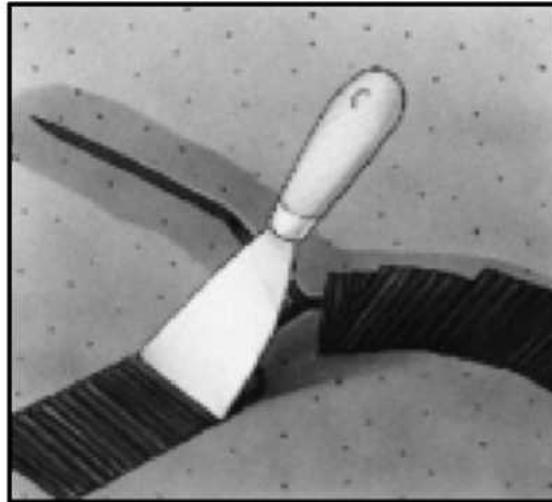
Рисунок 20. Обработка трещин Рисунок 21. Заполнение трещин грунтовкой Ceresit CT 17. материалами группы Ceresit CN.
