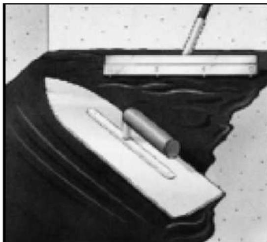
Рисунок 24. Нанесение растворной смеси на основание. Рисунок 25. Распределение смеси на поверхность основания. Рисунок 26. Распределение смеси игольчатым валиком.
