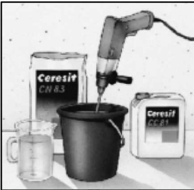
Рисунок 11. Приготовление адгезионного слоя.
