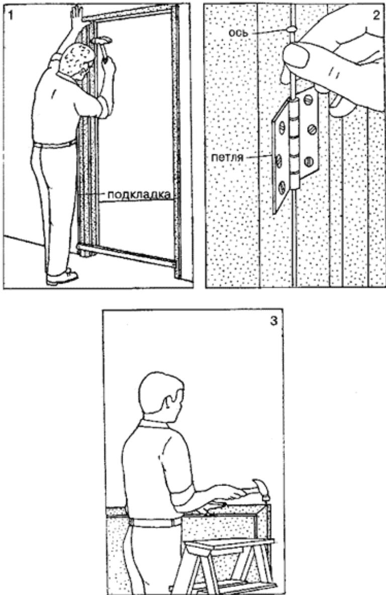
Рис.9. Крепление дверной коробки к стене
