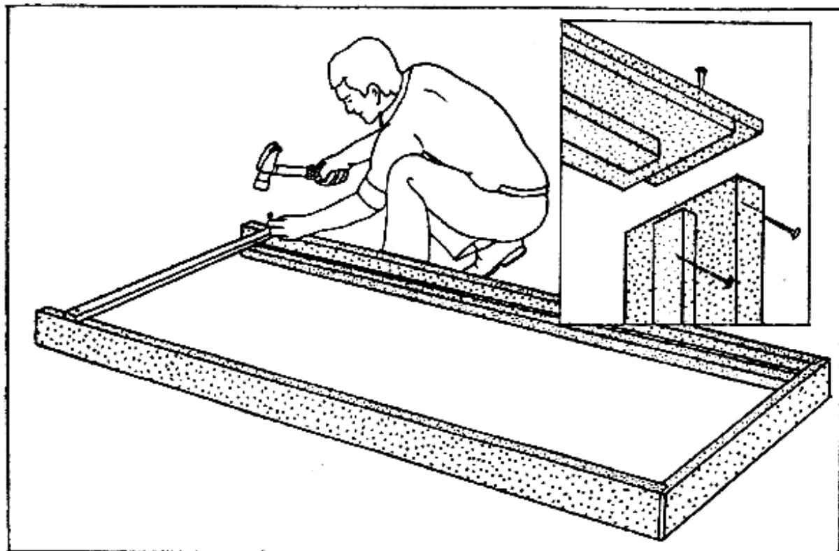
Рис.8. Сборка и установка дверной коробки
