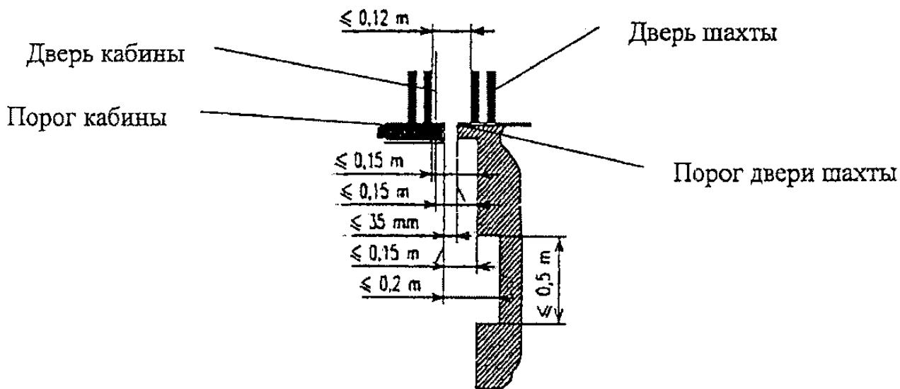
Рис. 3. Расстояния между элементами кабины и шахты
