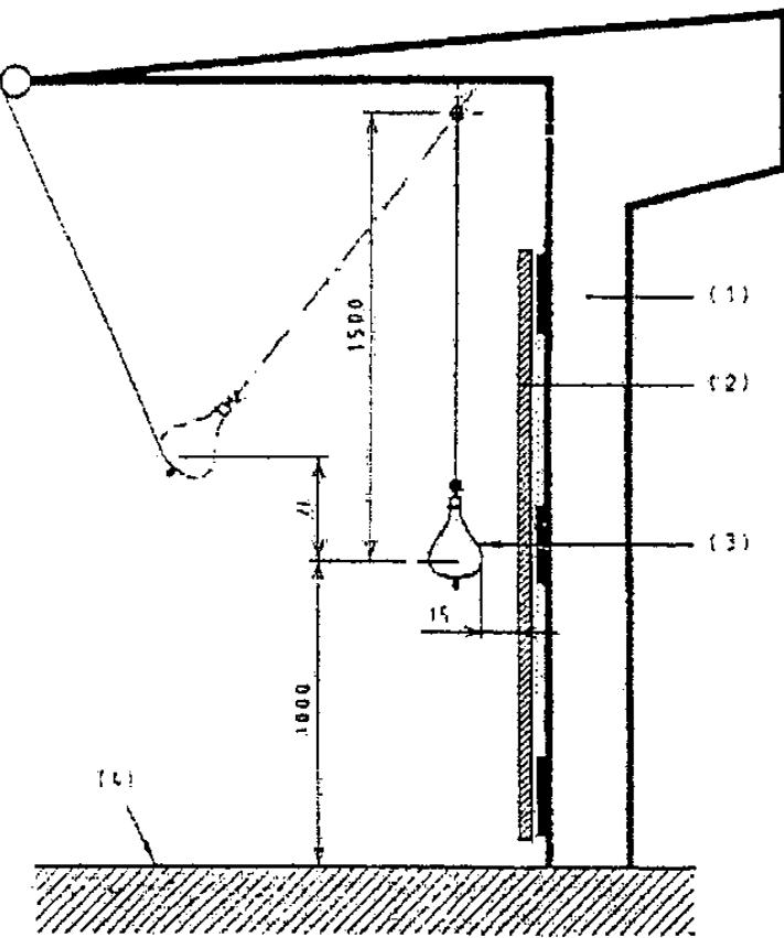
1 - рама; 2 - испытываемая стеклянная панель; 3 - маятник; 4 - уровень пола, относящийся к испытываемой стеклянной панели; Н - высота падения
