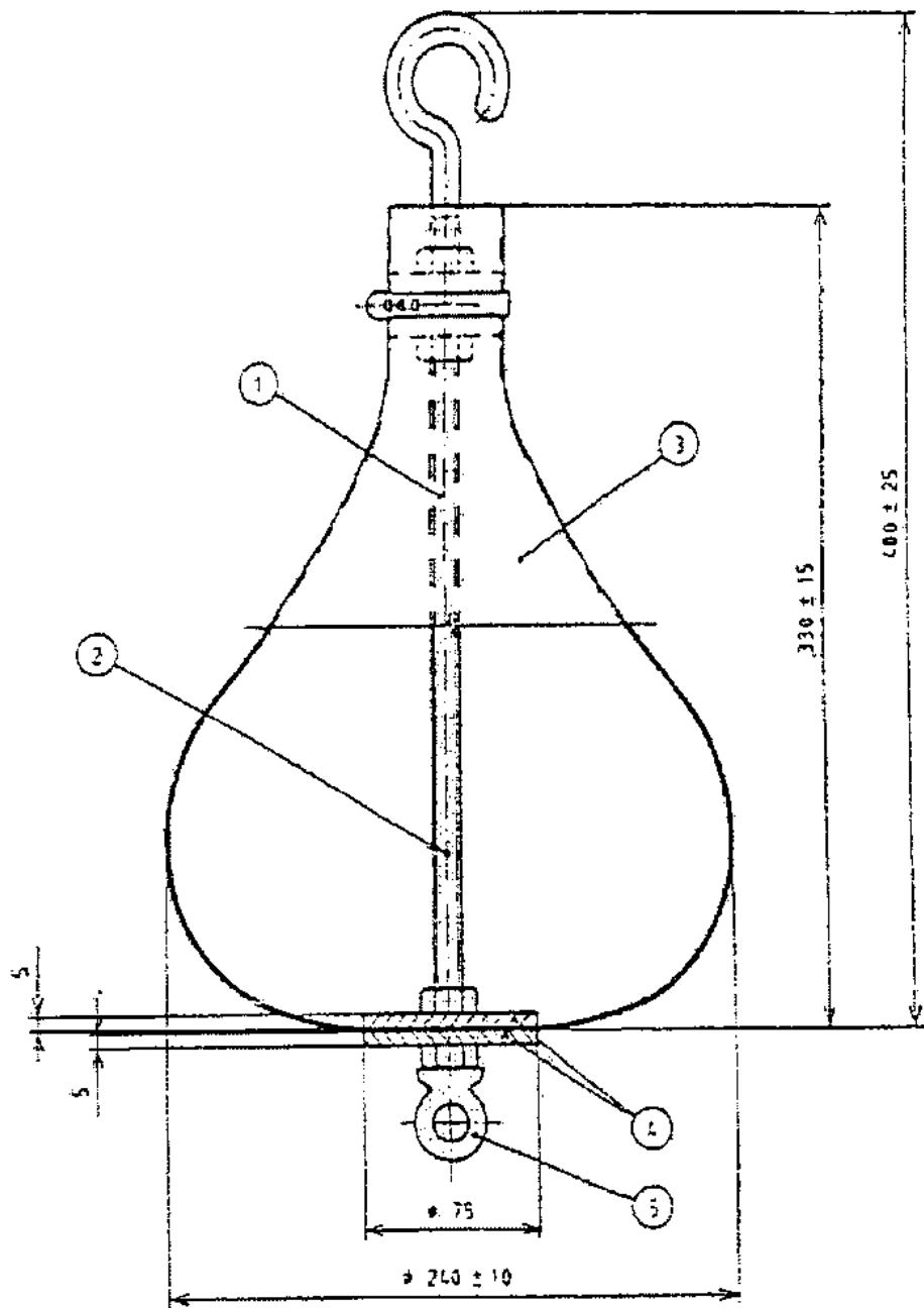
1 - стержень с нарезанной резьбой; 2 - базисная точка для измерения высоты падения в плоскости максимального диаметра; 3 - кожаный мешок; 4 - стальной диск; 5 - крепление пускающего приспособления.
