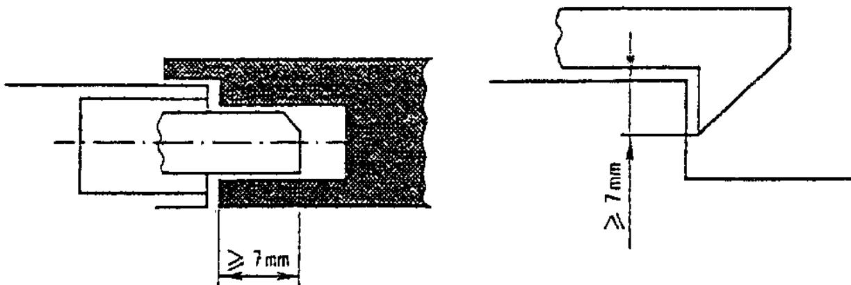
Рис. 5. Запирающее устройство автоматического замка двери шахты
