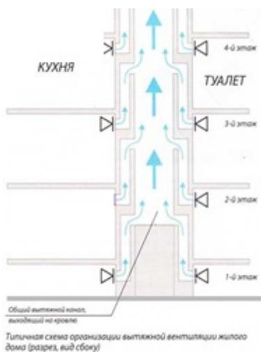
**Вентиляция естественная (аэрация)** - воздухообмен, осуществляемый либо под действием разности удельных весов (температур) наружного и внутреннего воздуха, либо под влиянием ветра, либо совместным их действием, а также комплекс технических средств для реализации такого воздухообмена.
