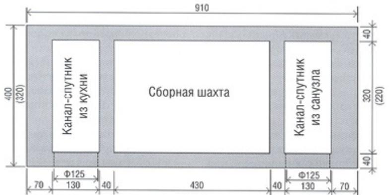
Поперечное сечение вентиляционного блока с двумя каналами-спутниками
