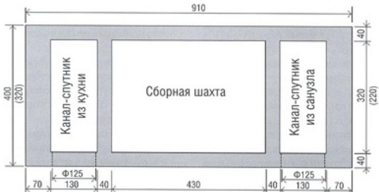
Поперечное сечение вентиляционного блока с двумя каналами-спутниками
