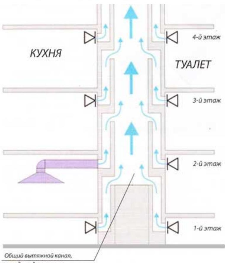
Типичная схема организации вытяжной вентиляции жилого дома (разрез, вид сбоку)
