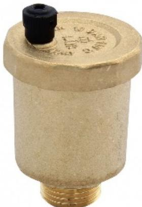
Воздухоотводчики/ воздушники автоматического типа функционируют в автономном режиме. Откручивать, открывать ничего не нужно. Устройство выполняет свои функции в автоматическом режиме. Монтируют их в вертикальном положении в наиболее высоких частях отопительной системы, где возможно скопление воздушных масс (квартиры крайних верхних этажей дома).
