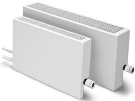
Конвектор малой глубины с диаметром условного прохода труб 20 мм. Материалом для изготовления конвекторов «Универсал» служит сталь. Нагревательный элемент изготовлен из цельнотянутой трубы, обладающей свойством выдерживать высокое давление, что позволяет использовать конвектор «Универсал» в отопительных системах с практически любым давлением. Конструкция конвектора представляет собой отопительный прибор с трубчато-пластинчатым нагревательным элементом и стальным съемным травмобезопасным кожухом.
