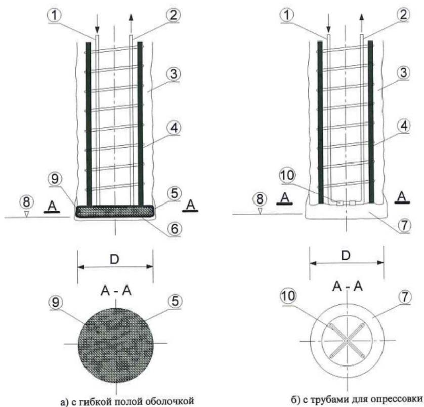
1 - труба для подачи раствора; 2- труба для контроля выхода раствора; 3 - скважина, заполненная бетоном; 4 - арматурный каркас; 5 - оболочка из прочного синтетического материала; 6 - полость оболочки; 7 - нагнетаемый раствор; 8 - проектная отметка сваи в уровне ее пяты; 9 - раствор внутри оболочки; 10 - клапаны
