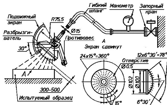
Рисунок 5 - Переносное устройство для проверки защиты от дождя и обрызгивания водой;
