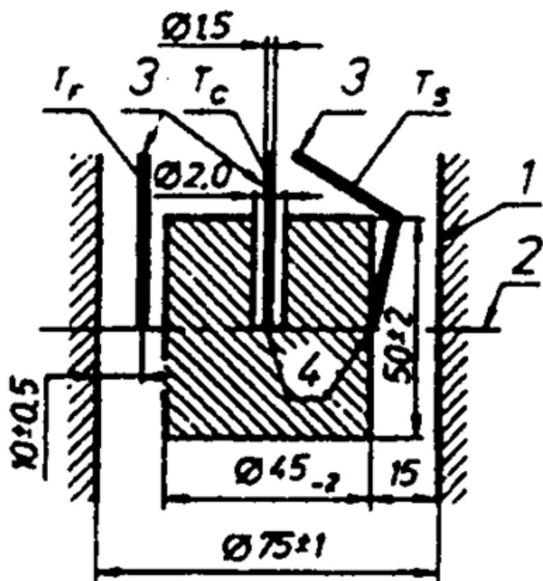
$T_f$  — печная термопара;  $T_c$  — термопара в центре образца;  $T_s$  — термопара на поверхности образца; 1 — стенка печи; 2 — середина высоты постоянной температурной зоны; 3 — термопары в защитном кожухе; 4 — контакт термопар с материалом
