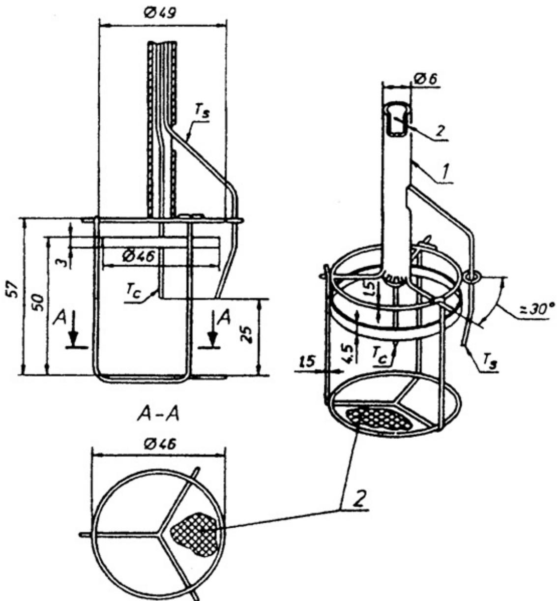
$T_c$  — термопара в центре образца;  $T_s$  — термопара на поверхности образца; 1 — трубка из нержавеющей стали; 2 — сетька (размер ячейки 0,9 мм, диаметр проволоки 0,4 мм)
