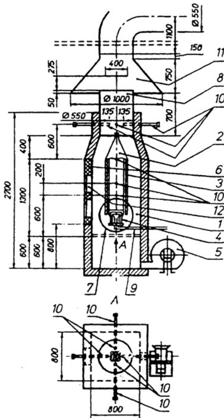
1 — камера сжигания; 2 — держатель образца; 3 — образец; 4 — газовая горелка; 5 — вентилятор подачи воздуха; 6 — дверца камеры сжигания; 7 — диафрагма; 8 — вентиляционная труба; 9 — газопровод; 10 — термопары; 11 — вытяжной зонт; 12 — смотровое окно
