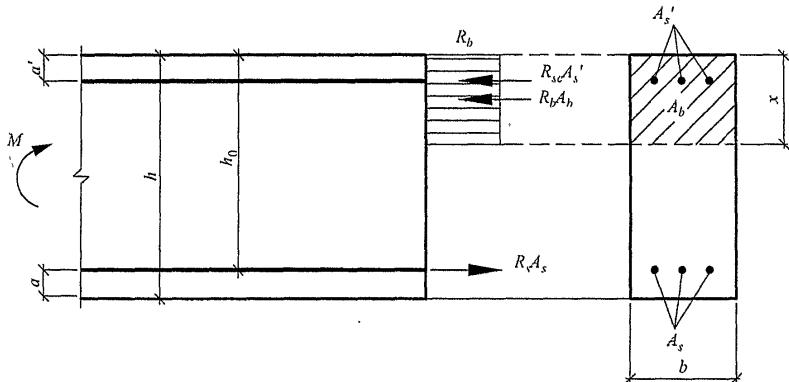
**Рисунок 8.1 – Схема усилий и эпюра напряжений в сечении, нормальном к продольной оси изгибающего железобетонного элемента, при его расчете по прочности**
