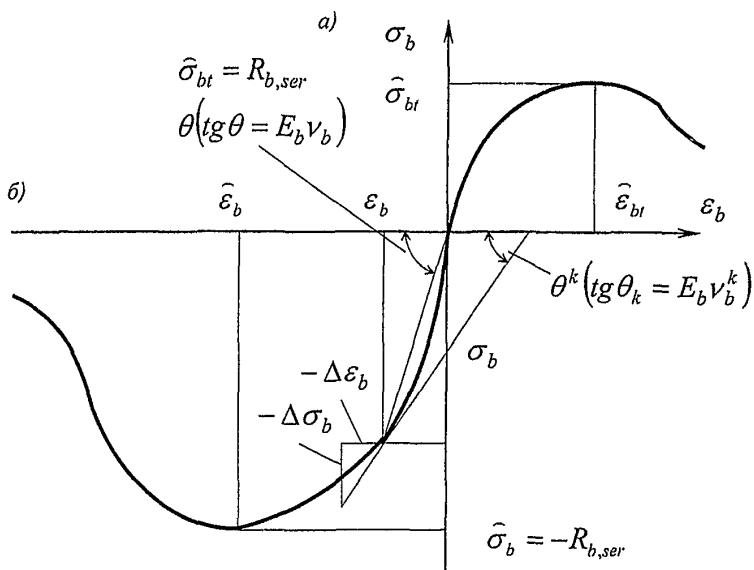
Рисунок Г.1 – Криволинейные диаграммы деформирования бетона
