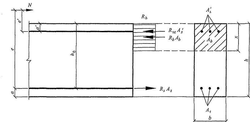
*Рисунок 8.3 – Схема усилий и эпюра напряжений в сечении, нормальном к продольной оси внерадиально сжатого железобетонного элемента, при расчете его по прочности*
