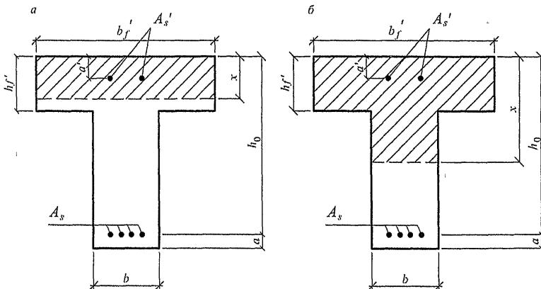
**Рисунок 8.2 – Положение границы сжатой зоны в сечении изгибающего железобетонного элемента**
