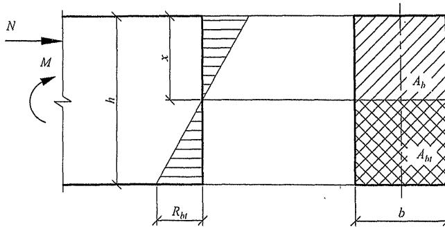
**Рисунок 7.2 – Схема усилий и эпюра напряжений в сечении, нормальному к продольной оси изгибаляемого (внеклентренно сжатого) бетонного элемента, рассчитываемого по прочности с учетом сопротивления бетона растянутой зоны**
