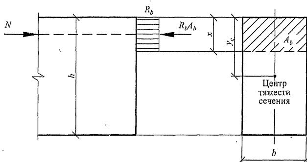
**Рисунок 7.1 – Схема усилий и эпюра напряжений в сечении, нормальному к продольной оси внецентренно сжатого бетонного элемента, рассчитываемого по прочности без учета сопротивления бетона растянутой зоны**
