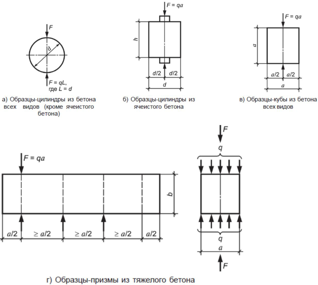
Рисунок 3 — Схемы испытания на растяжение при раскалывании
