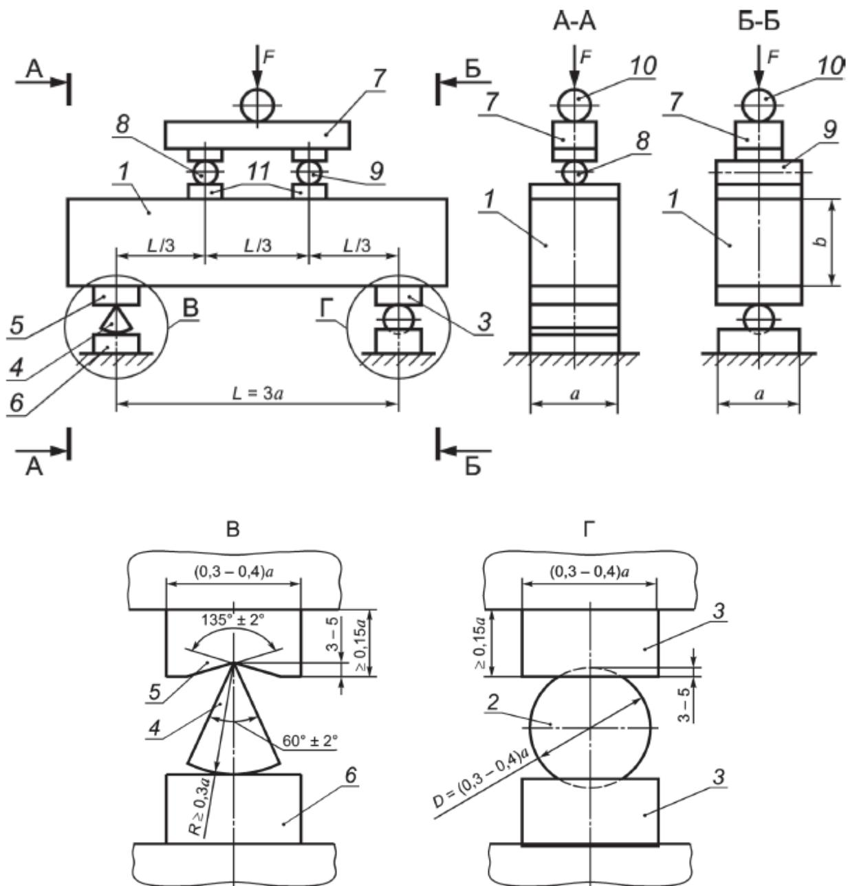
1 — образец; 2 — шар; 3 — опорная подушка; 4 — качающаяся призма; 5 — опорная сегментная подушка; 6 — опорная плоская подушка; 7 — распределительная траверса; 8 — шарниро-неподвижная опора; 9 — шарниро-подвижной опора; 10 — шаровой шарнир; 11 — стальная опорная пластина
