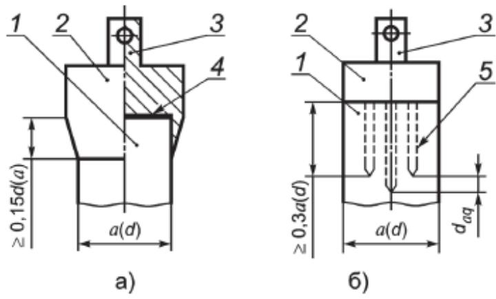
1 — образец; 2 — захват; 3 — концевой элемент шарнира Гука; 4 — клей;
