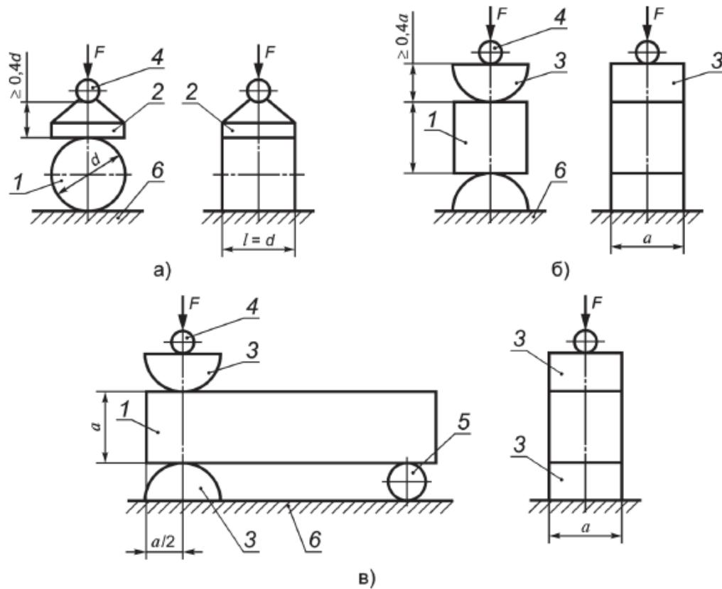
1 — образец; 2 — нагружочное устройство (плита) при испытании образца-цилиндра; 3 — нагружочное устройство (колпачий стержень) при испытании образца-куба, образца-призмы; 4 — шаровой шарнир; 5 — дополнительная шаровая опора; 6 — нижняя опорная плита пресса (испытательной машины)
