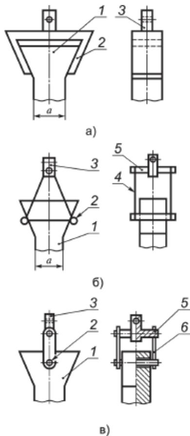
1 — образец; 2 — захват; 3 — концевой элемент шарнира Гука;
