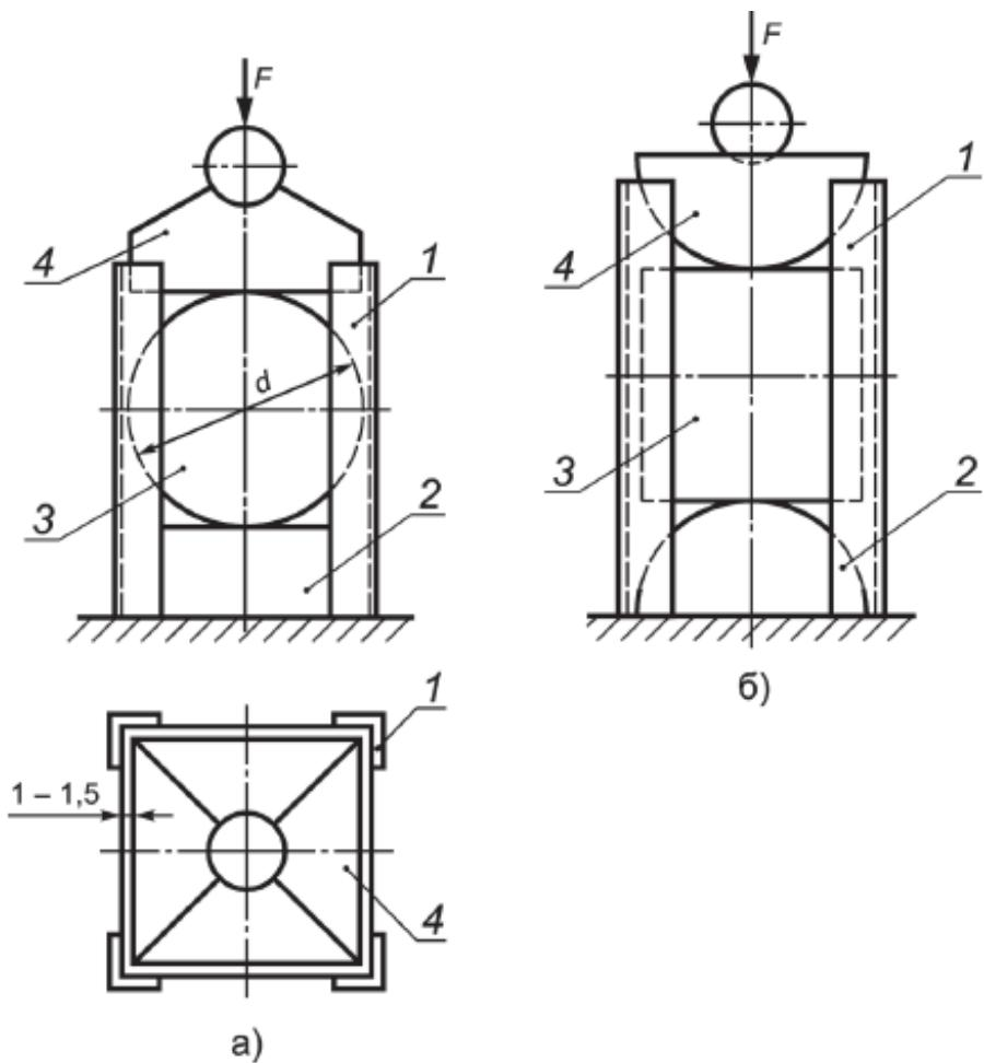
1 — направляющие кондуктора; 2 — нижнее нагруженное устройство;
