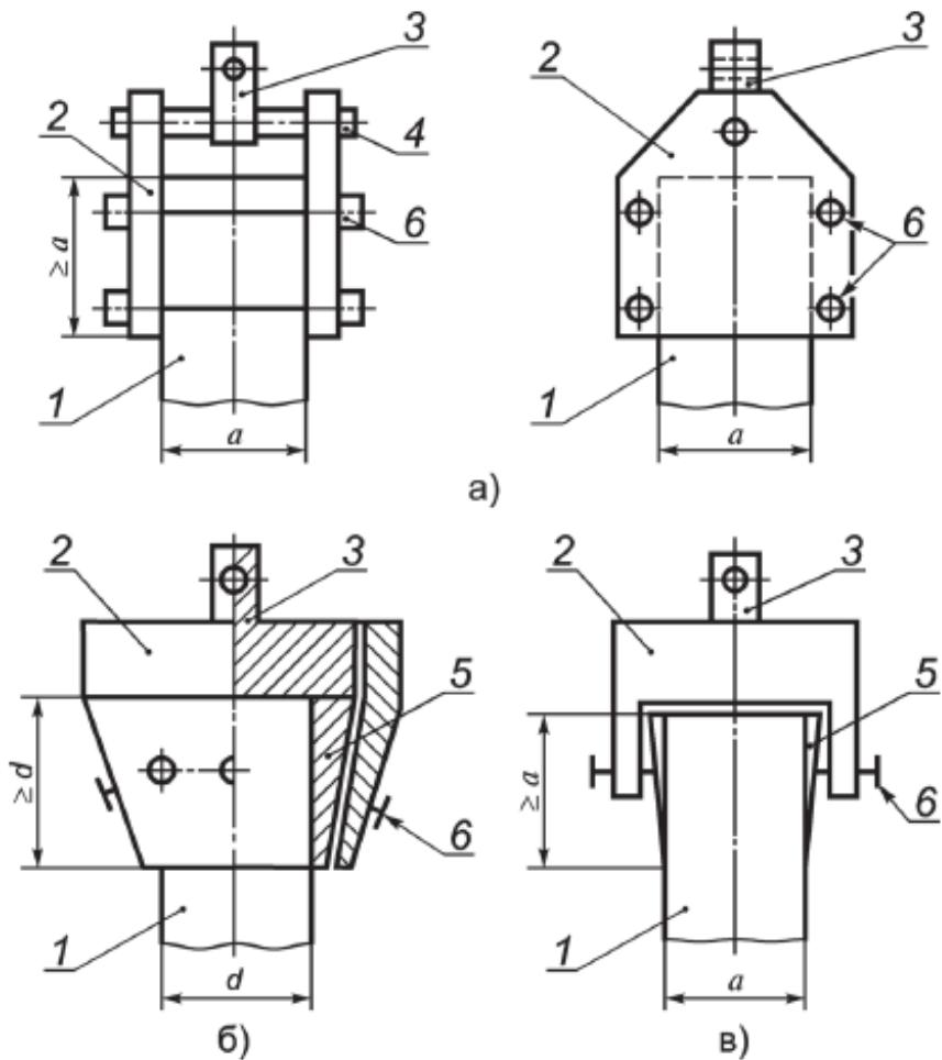
1 — образец; 2 — захват; 3 — концевой элемент шарнира Гука; 4 — ось;
