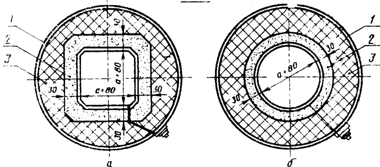
1 - металлический кожух; 2 - муфель из жаростойкого раствора с нагревателем из проволоки повышенным омическим сопротивлением; 3 - теплоизоляция; а - размер стороны призмы или диаметра цилиндра; Н - высота образца.
