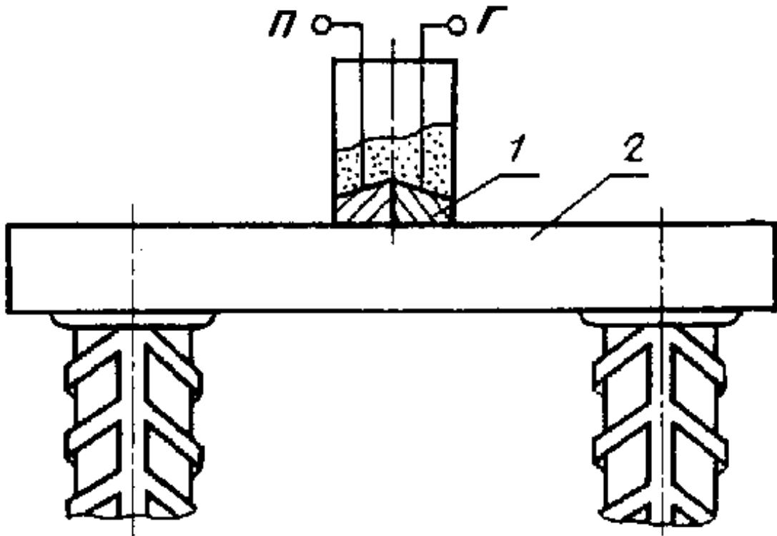
1 - искатель; 2 - пластина закладной детали; Г - вывод к генератору ультразвуковых
