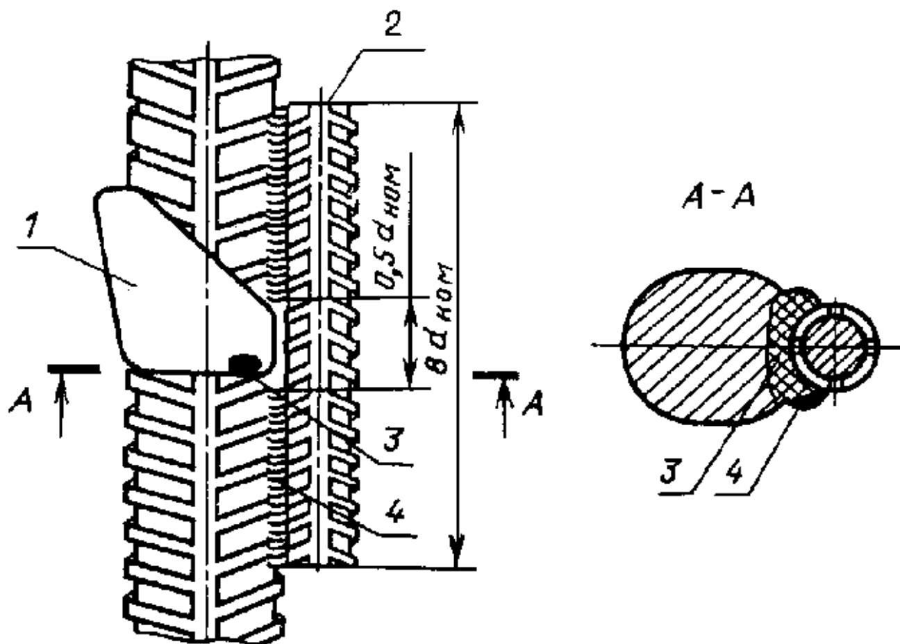
1 - сварной шов; 2 - накладка; 3 - дефект; 4 - протяженные сварные швы
