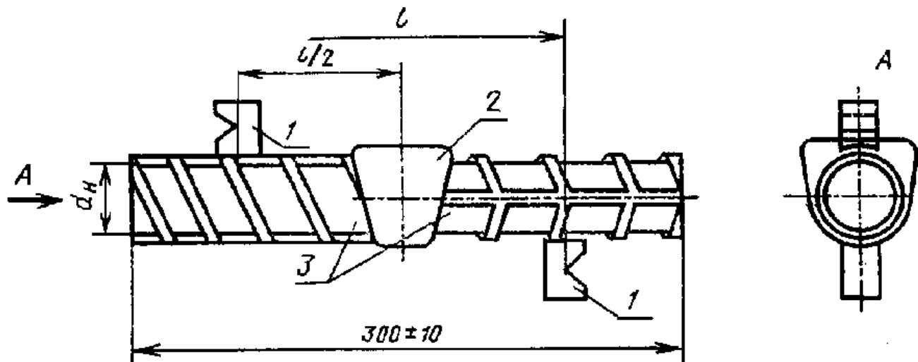
1 -искатели; 2 - сварное соединение горизонтальных стержней (испытательный образец, выполненный в инвентарной форме); 3 -стержни, развернутые на  $(90 \pm 5)^\circ$
