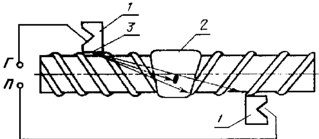
1 - наклонные искатели; 2 - сварное соединение; 3 - метка , соответствующая точке выхода луча (ГОСТ 14782-86); Г - вывод к генератору ультразвуковых колебаний; П - вывод к приемнику
