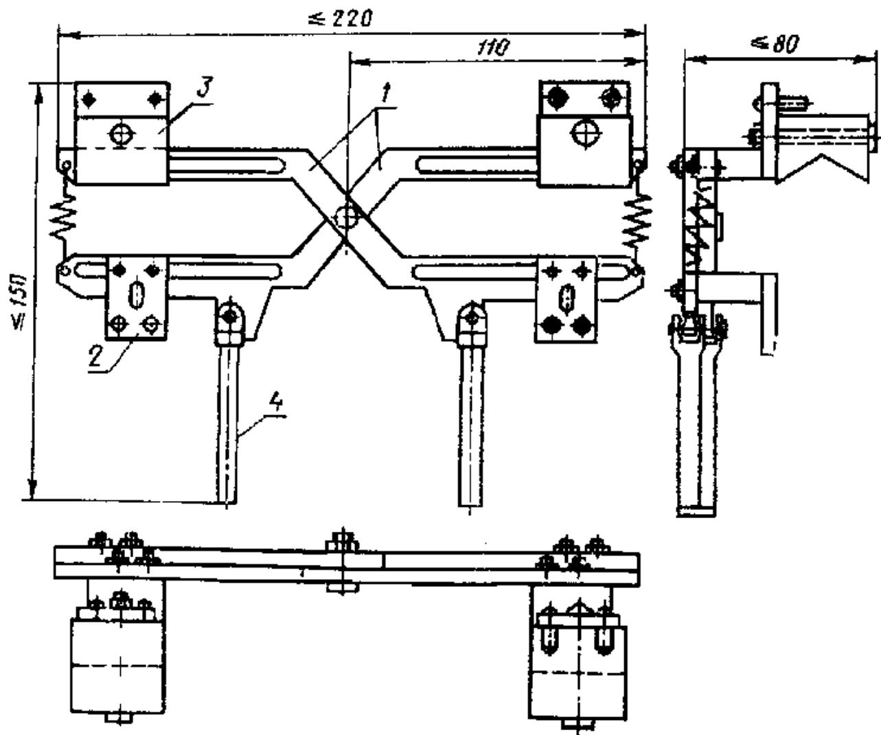
1 - рычаги; 2 - планка крепления искателя; 3 - фиксатор; 4 - рукоятка
