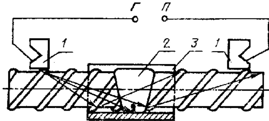
1 - наклонные искатели; 2 - сварное соединение; 3 - скоба-накладка; Г - выход к генератору ультразвуковых колебаний; П- вывод к приемнику
