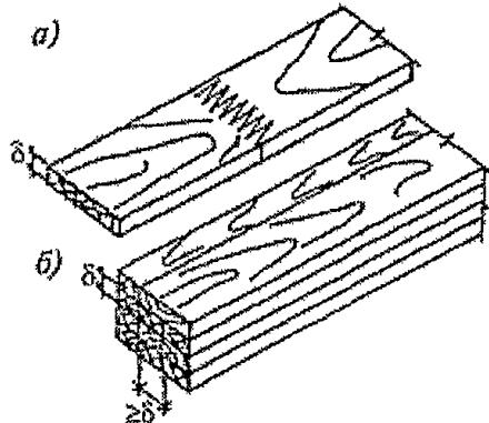
а — при стыковании отдельных слоев по длине зубчатым шилом, выходящим на пласть;
