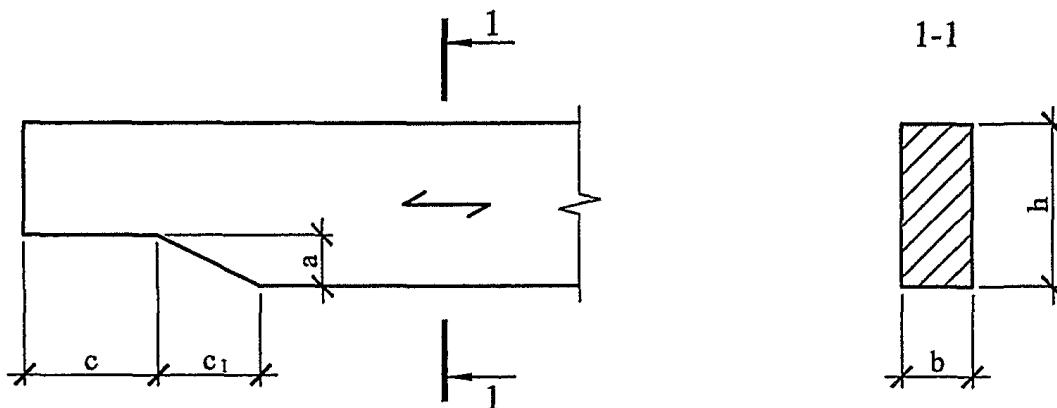
Рисунок 19 — Скошенная подрезка конца балки
