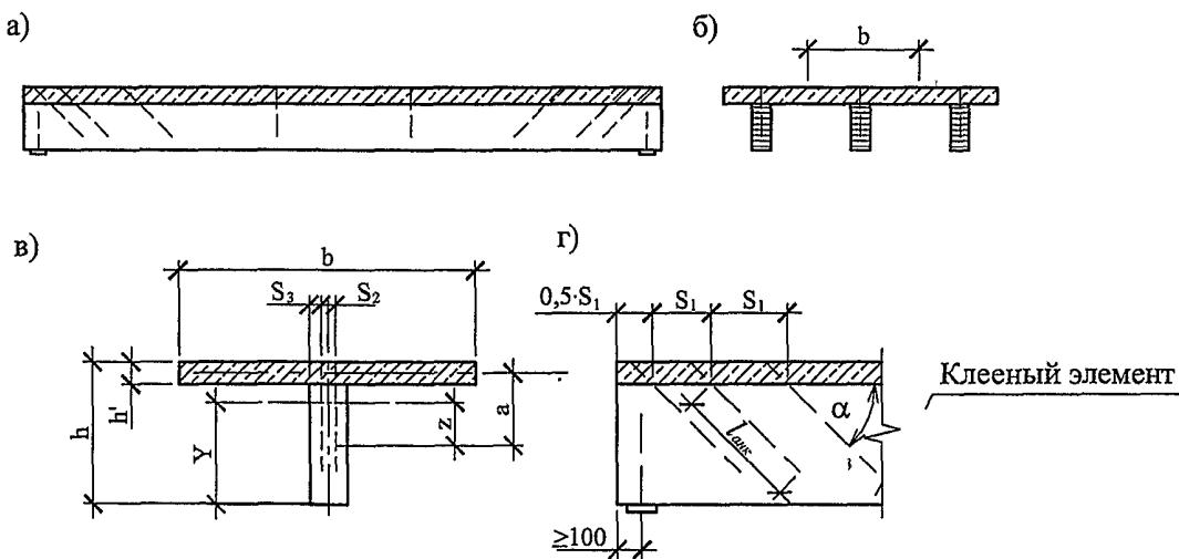
а — общий вид; б — поперечное сечение; в — геометрические характеристики поперечного сечения;
