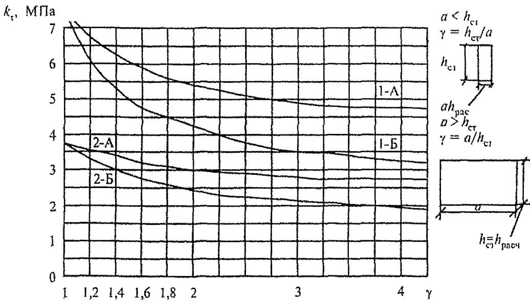
1—А — для бакелизированной фанеры марок ФБС и ФБСВ толщиной 7 мм и более при направлении волокон наружных слоев параллельно малой стороне панели; 1—Б — для бакелизированной фанеры марок ФБС и ФБСВ толщиной 7 мм и более при направлении волокон наружных слоев перпендикулярно малой стороне панели; 2—А, 2—Б — то же, для березовой фанеры марки ФСФ толщиной 8 мм и более
