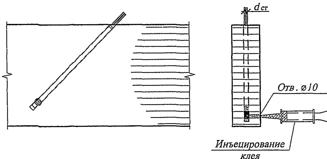
**Рисунок И.2 — Схема подачи клея под давлением**
