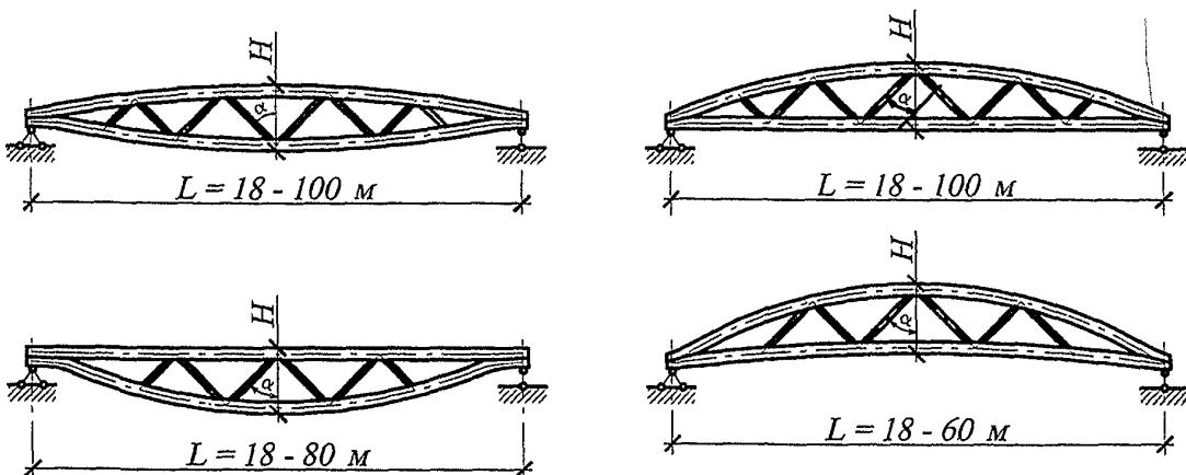
Рисунок 23 — Схемы линзообразных ферм
