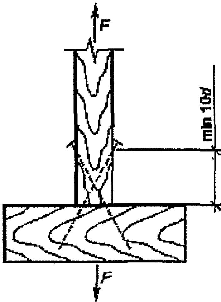
**Рисунок 14 — Наклонная забивка гвоздей**
