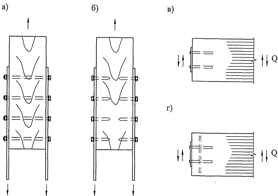
*a* — на болтах и шпильках; *b* — на глухих цилиндрических нагелях; *v* — на глухих цилиндрических нагелях, установленных в торец клееного элемента; *g* — то же, с усилением поперечным армированием
