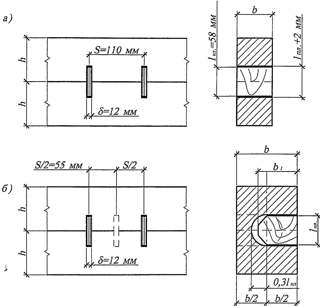
*a* — со сквозными пластинками; *б* — с глухими пластинками
