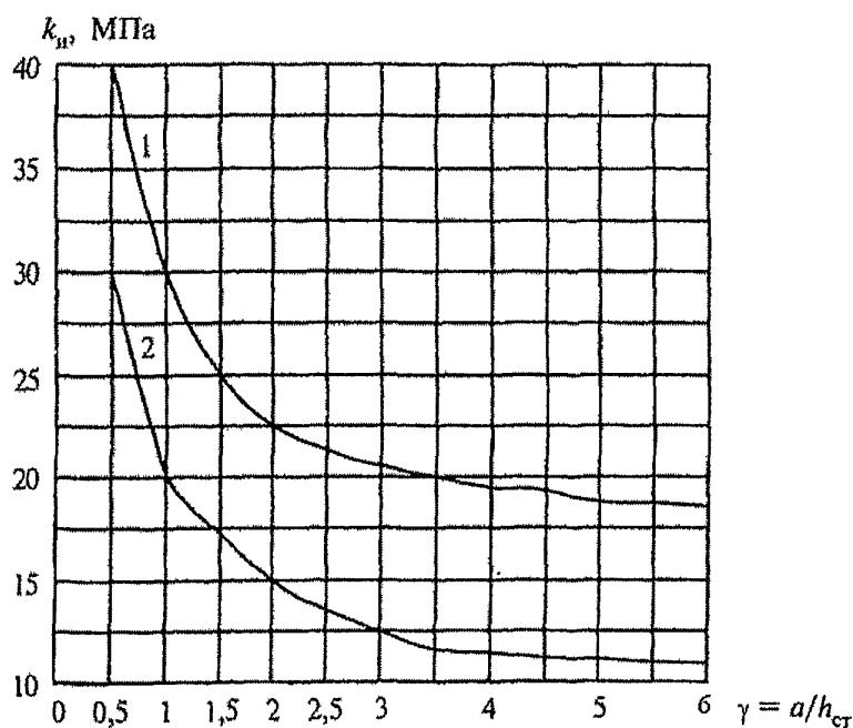
1 — для бакелизированной фанеры марок ФБС и ФБСВ толщиной 7 мм и более; 2 — для березовой фанеры марки ФСБ толщиной 8 мм и более. В выражении  $\gamma = a/h_{cr}$   $a$  — расстояние между ребрами жесткости балки;  $h_{cr}$  — высота стенки между внутренними гранями полок
