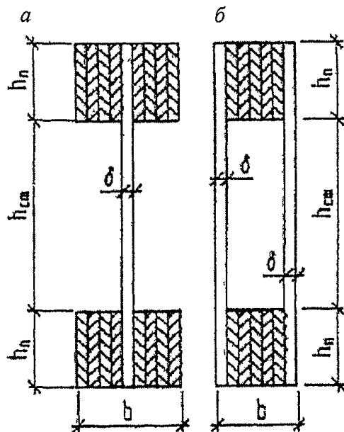
а — двутаврового сечения; б — коробчатого сечения
