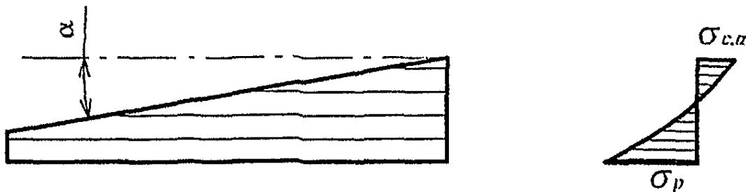
**Рисунок 21 — Односкатная балка**
