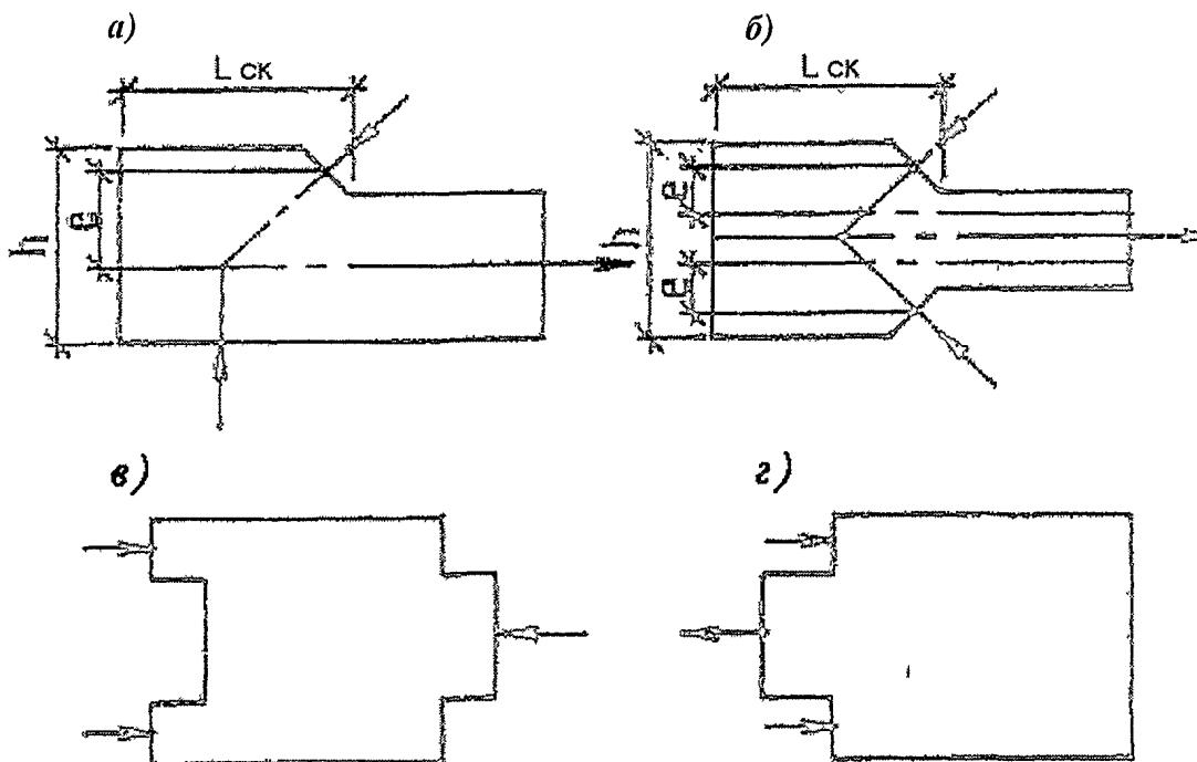
а — несимметричная; б — симметричная; в, г — схемы скальвания в соединениях
