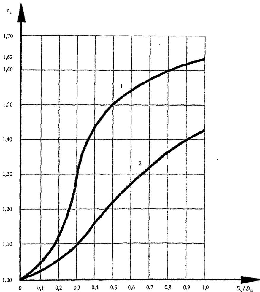
$\eta_b$  – коэффициент несущей способности деталей;  $D_o/D_n$  – отношение наружного диаметра ответвления тройника к наружному диаметру основной трубы тройника
