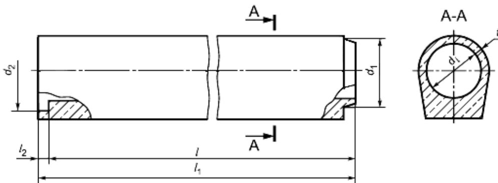
Рисунок А.6 - Общий вид труб типа ТФП
