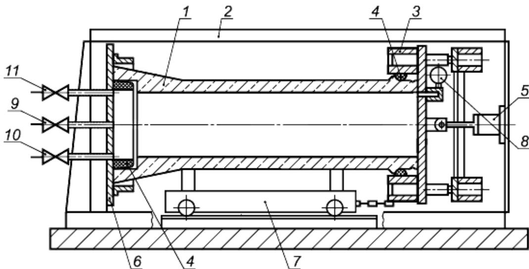
1 - труба; 2 - рама гидростенда; 3 - подвижная заглушка; 4 - уплотнительные кольца; 5 - гидроцилиндр; 6 - неподвижная заглушка; 7 - тележка; 8 - манометр; 9 - вентиль подачи воды; 10 - вентиль слива воды; 11 - воздушный вентиль
