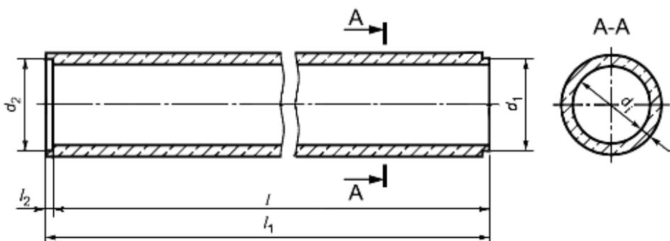
Рисунок А.3 - Общий вид труб типа ТФ
