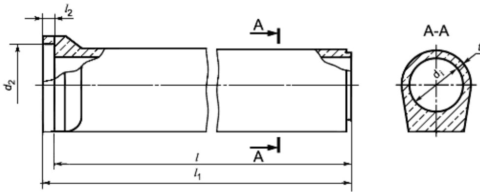
Рисунок А.4 - Общий вид труб типа ТП
