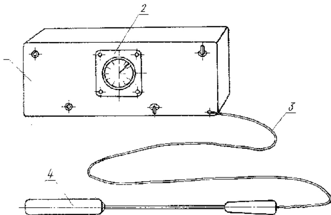
1 - корпус прибора; 2 - счетчик; 3 - провод;
