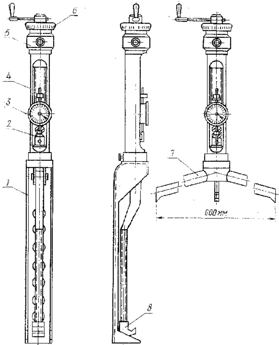
1 - упор; 2 - пружина; 3 - индикатор; 4 - корпус; 5 - шарнир;
