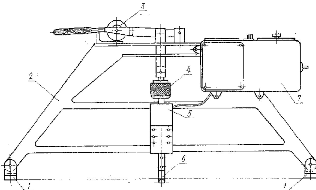
*1* - упоры; *2* - рама; *3* - эксцентрик; *4* - регулировочная гайка; *5* - упругий элемент с проволочными тензорезисторами (размещается под кожухом); *6* - крючок; *7* - коробка с элементами электрической схемы
