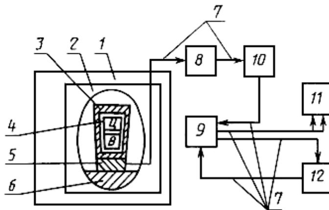
1 - термостат; 2 - калориметрический блок; 3 - камера; 4 - ячейка; 5 - термомер; 6 - теплоотвод;
