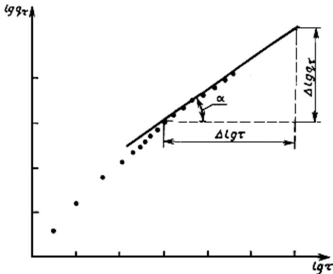
Определяют значение коэффициента ( $k$ ) как тангенс угла наклона ( $\alpha$ ) прямолинейного участка. Значение ( $k$ ) округляют до трех значащих цифр.
