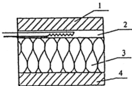
1 - нагреватель; 2 - теплометр; 3 - испытываемый образец; 4 - холодильник
