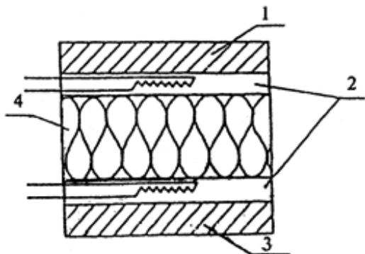
1 - нагреватель; 2 - теплометры; 3 - холодильник; 4 - испытываемый образец
