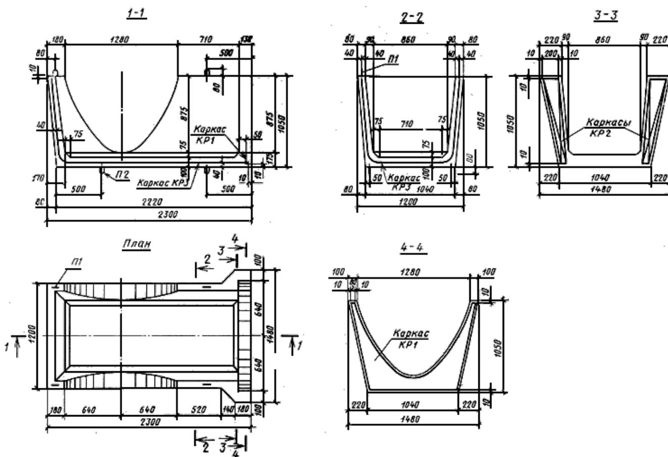
Примечание. Проектное положение петель фиксируется инвентарными зажимами или вязальной проволокой.
