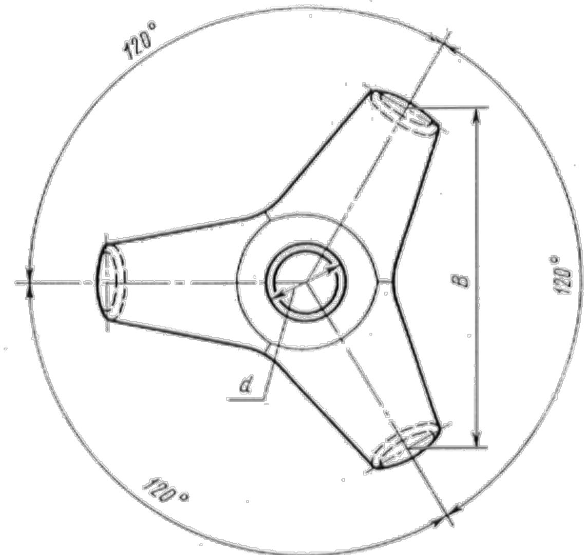
2.5. Тетраподы для берегозащитных сооружений, расположенных в приурезовой зоне побережья с галечными наносами с интенсивным волнением
