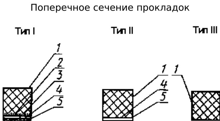
1 - пенополиуретановая основа; 2 - клеевое или сварное соединение;
