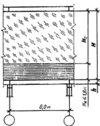
$H$  - полна высота слоя кладки над балкой;  $H_k$  - высота слоя кладки над балкой до проема;
