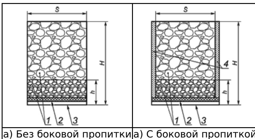
1 - полиуретановая основа; 2 - клеевой слой, армированный стеклонитью (или без армирования); 3 - защитная антиадгезионная пленка; 4 - боковая пропитка;
