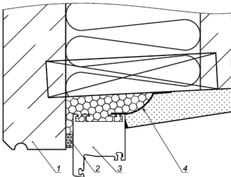
1 - ограждающая конструкция; 2 - уплотнительная лента; 3 - коробка; 4 - пароизоляционная лента
