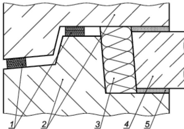
1 - уплотнительная лента; 2 - стеновая панель; 3 - вкладыш-утеплитель; 4 - плита перекрытия; 5 - цементно-песчаный раствор
