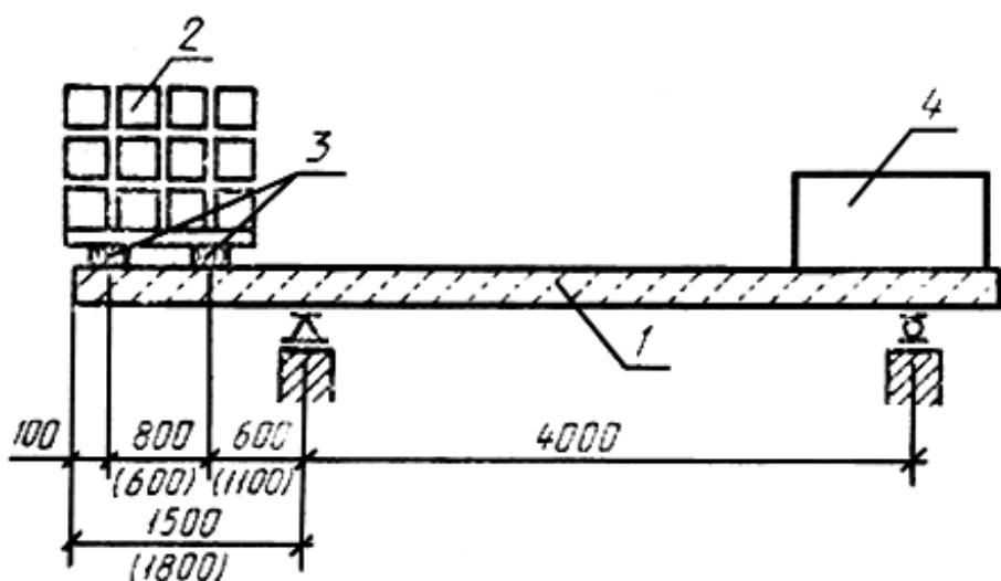
1 - испытуемая плита; 2 - нагрузка на всю ширину плиты;
