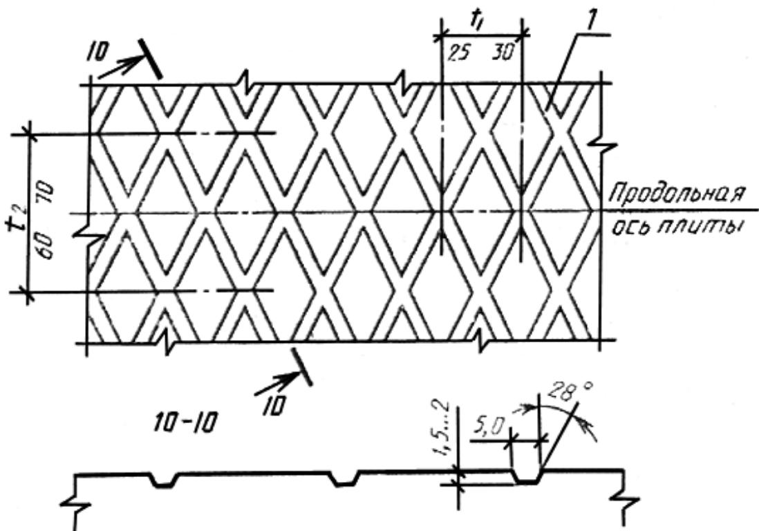
1 -рифление рабочей поверхности плиты
